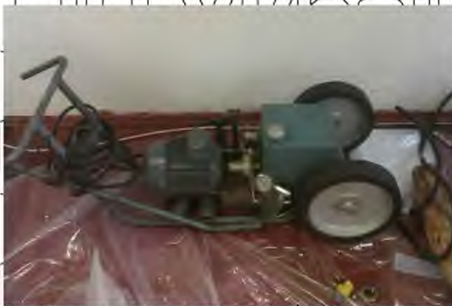
Мал. 4.2. Гідралічна насосна станція для приводу грейфера
