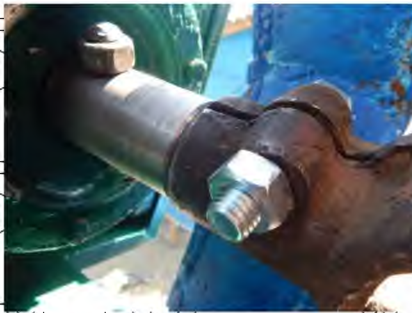
Рисунок 3.8 – Запобіжна муфта для регулювання максимального моменту, що крутить, на входному валу черв'ячної передачі
