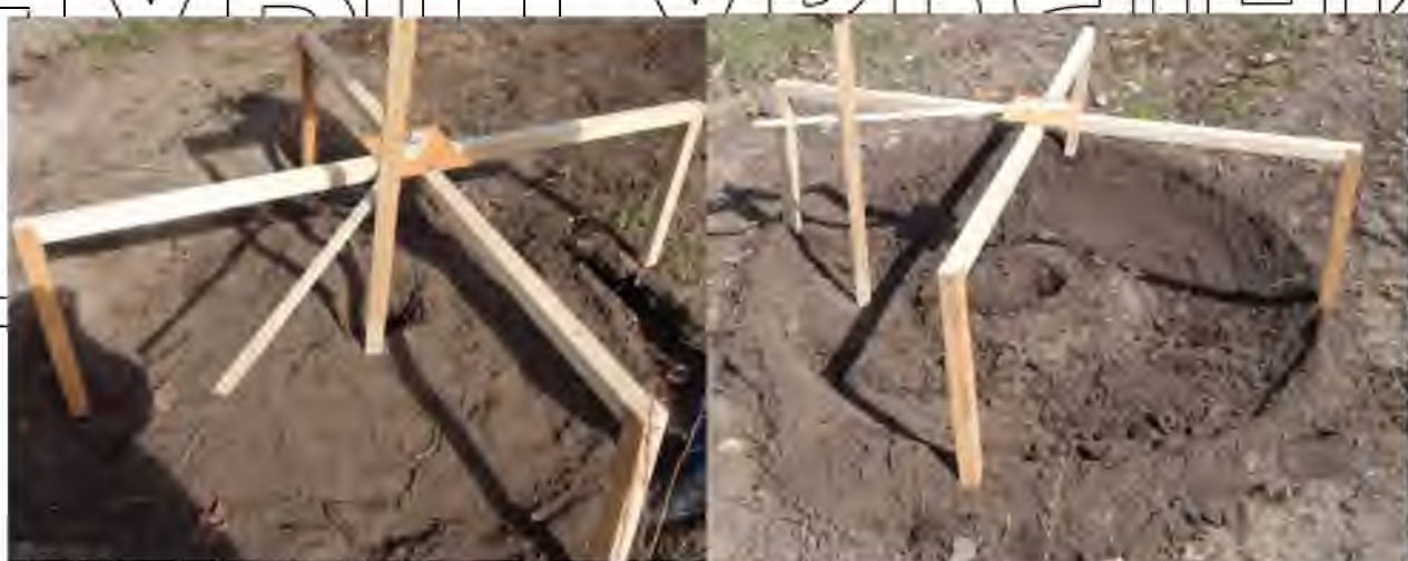
а – загальний вигляд, б – знімний транспортир, в – вимір параметрів мікропідвищення, р – вимір параметрів мікропідвищення Рисунок 3.6 – Пристрій для вимірювання поперечного та кругового профілів мікропідвищення (мікропониження)
