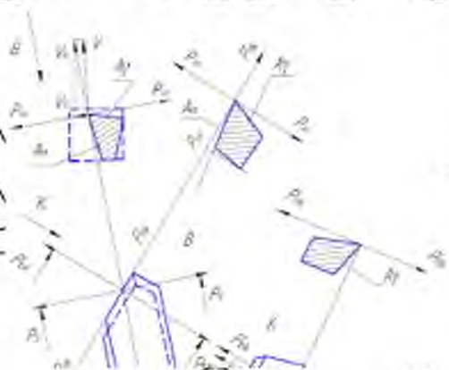
Рис. Геометричні параметри леза інструмента.
