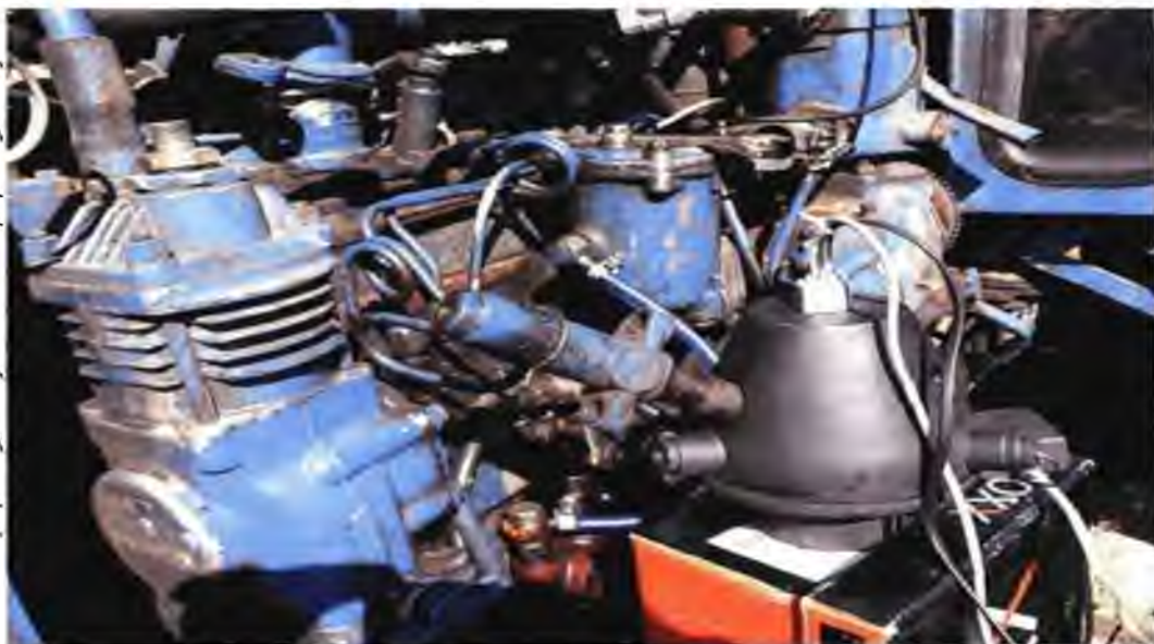
Рисунок 3.1. Встановлення форсунки в експериментальний зразок діагностичного стенду, безпосередньо на тракторі МТЗ 82
