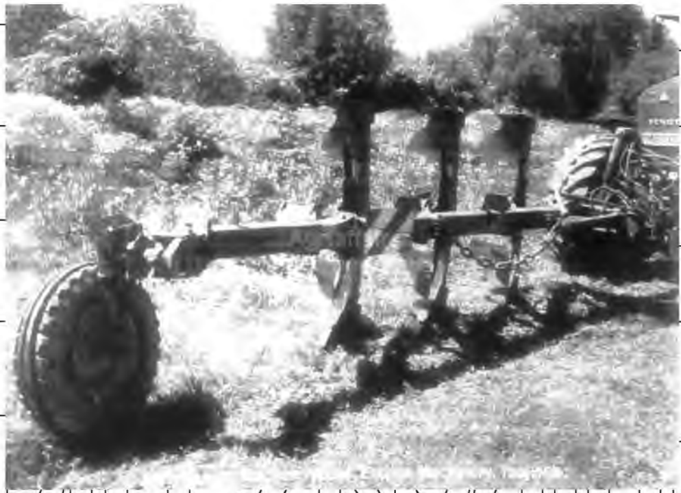
Рис. 1.5. Оборотний плуг з переднім фронтальним начіпленням.
