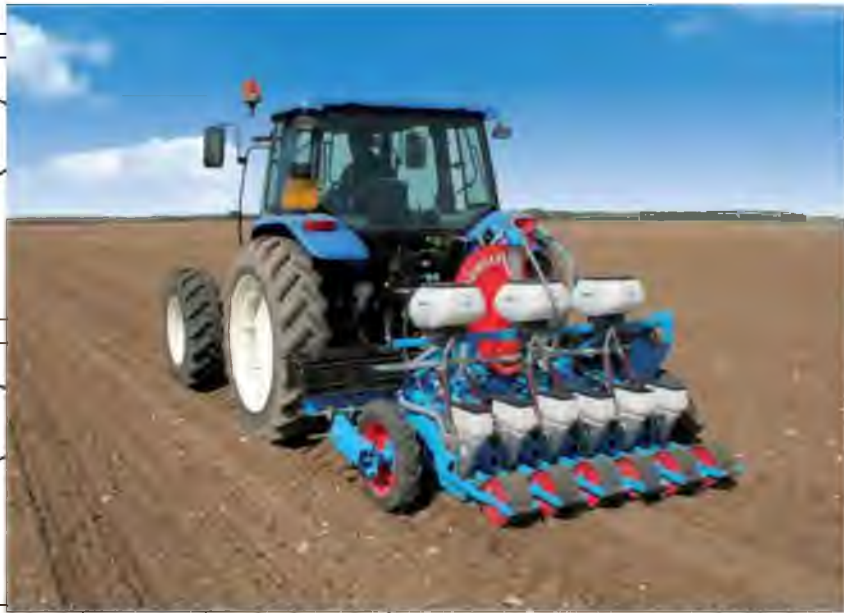
Рисунок 1.2. Сівалка точного висіву на задній начіпці.
