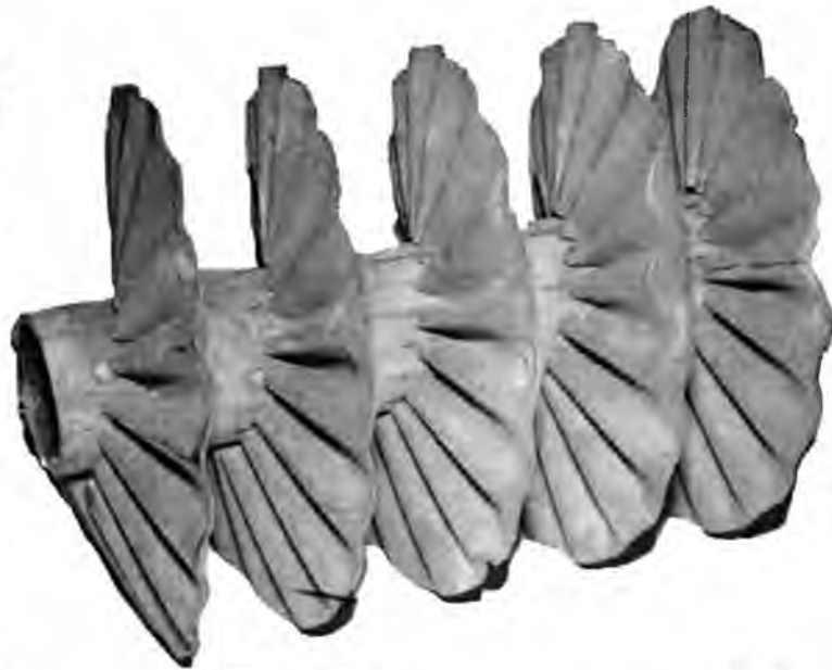
Рис. 3.16. Шнек з гофрованою гвинтовою спіраллю зі змінною амплітудою гофрів у радіальному напрямку
