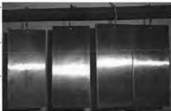
Рисунок 4.13 - Зовнішній вигляд зразків після 12-ти місячних натурно-стендових випробувань у закритому неопалювальному приміщенні.
