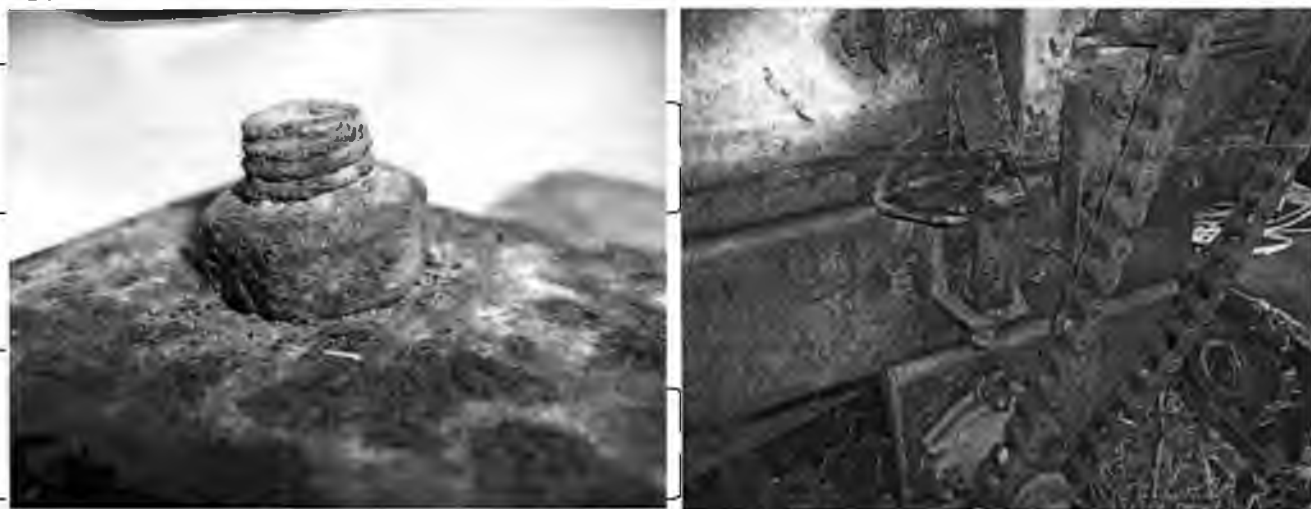
Рисунок 1.11- Характерні корозійно-механічні враження сільськогосподарської техніки (група ІІІ)
