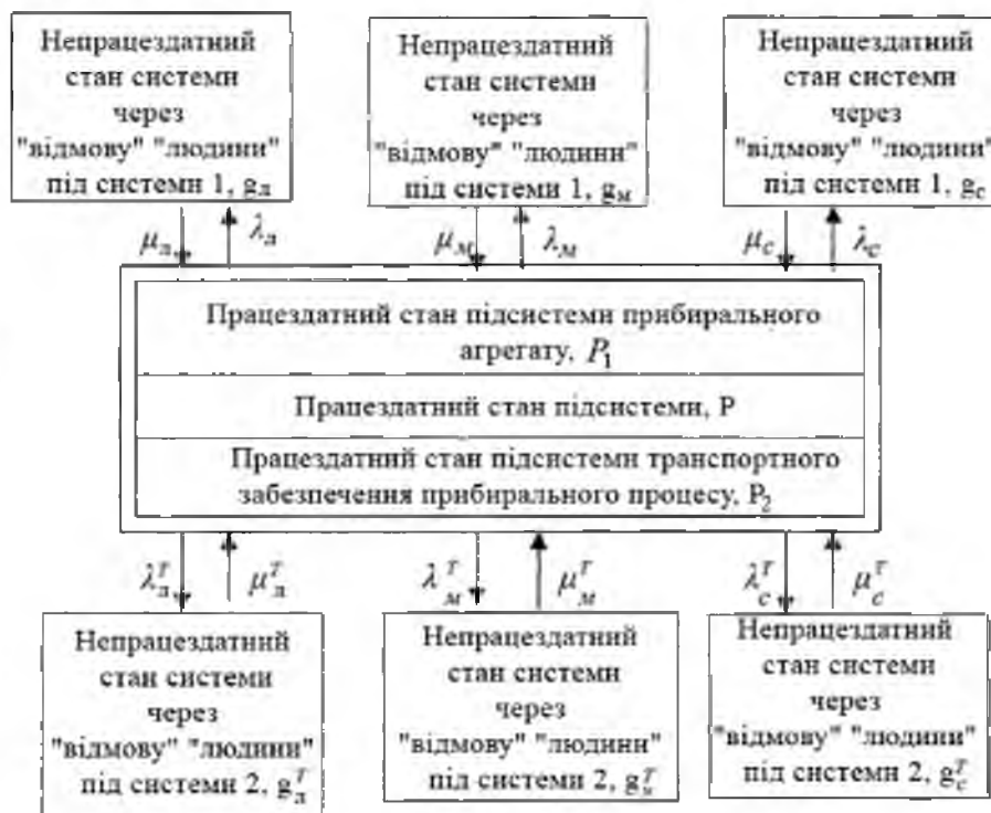
Рис. 2.4. Граф станів функціонування шестиеlementної системи прибирально-транспортного процесу
