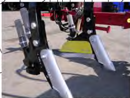
Рис. 1.14. Технічна схема та загальний вигляд сошників «Horsch – Агро-Союз»
