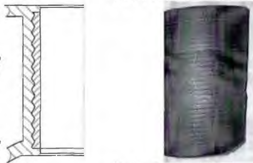
Рис. 1.4. Вставка циліндра з кільцевими канавками на зовнішній поверхні
