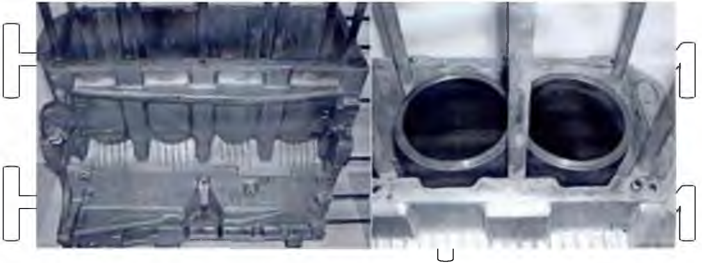
Рис. 1.3. Загальний вигляд блоку циліндрів із «мокрими» чавунними гільзами.
