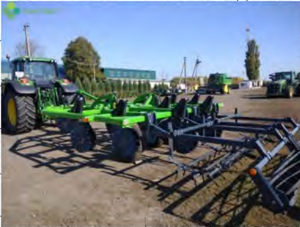
Рисунок 15 - Агрегат для вертикального обробітку ґрунту від компанії Amers Agro
