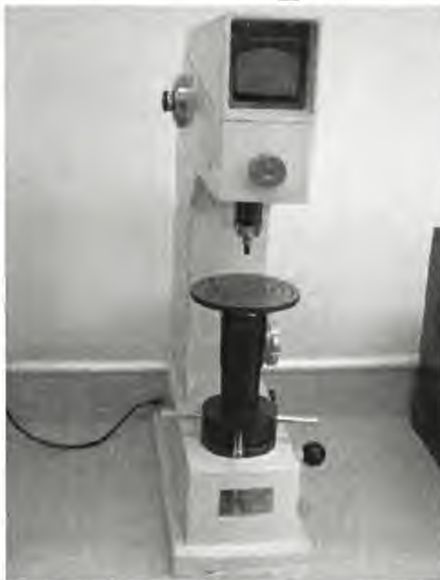
Рисунок 3.7. Загальний вигляд твердоміра HBRV-187,5
