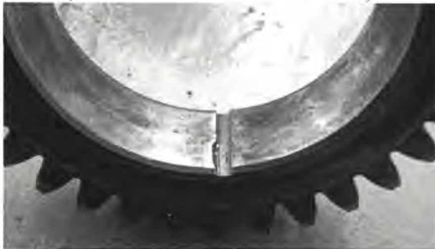
Рисунок 1.5. Порушення геометричних форм пазів валу або втулки: а) вал комбайну, б) колінчастий вал трактора John Deere 9420; в) шестерня газорозподільного механізму трактора.
