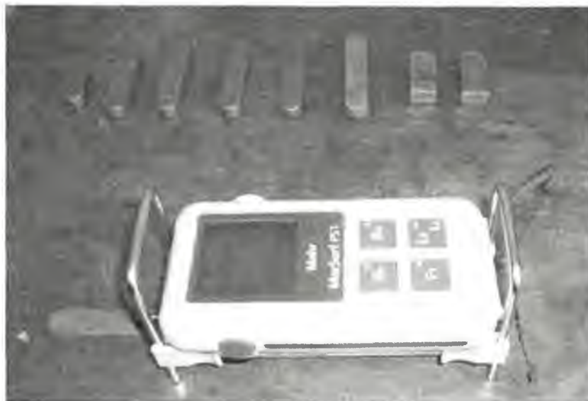
Рисунок 3.4. Загальний вигляд профілеграфу-профилеметра MarSurf PS 1
