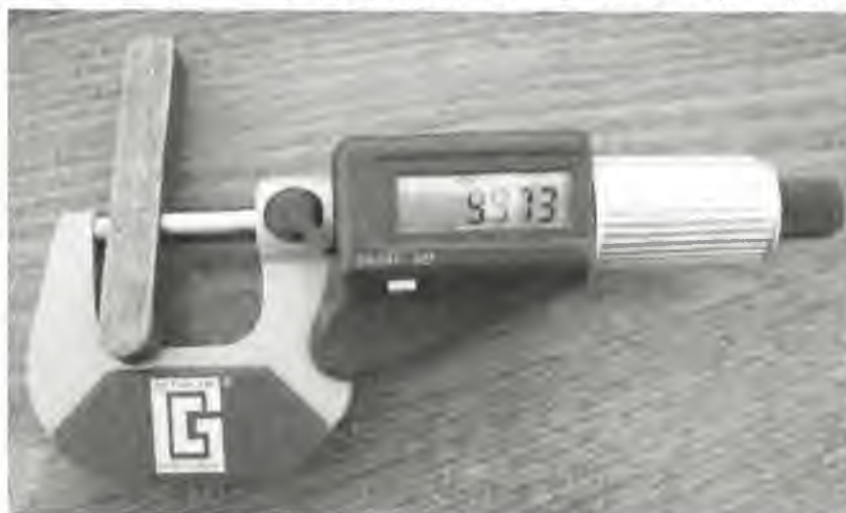
Рисунок 3.5. Загальний вигляд електронного мікрометра МКЦ-25
