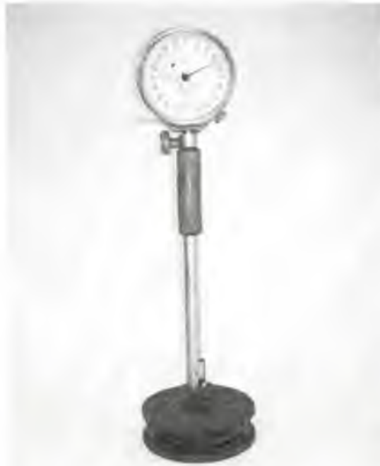
Рисунок 3.6. Загальний вигляд індикаторного нутроміра
