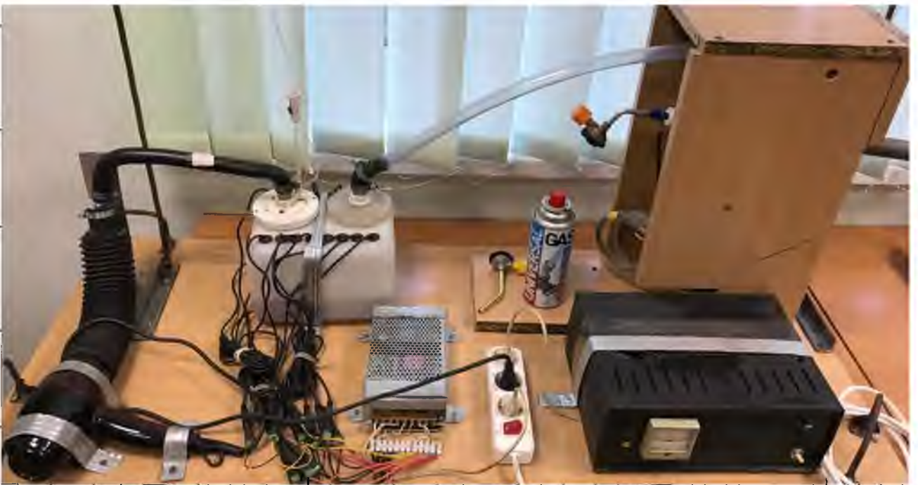
Рис.3.2. Натурний зразок пальноково системи з електромагнітним впливом на процеси горіння.
