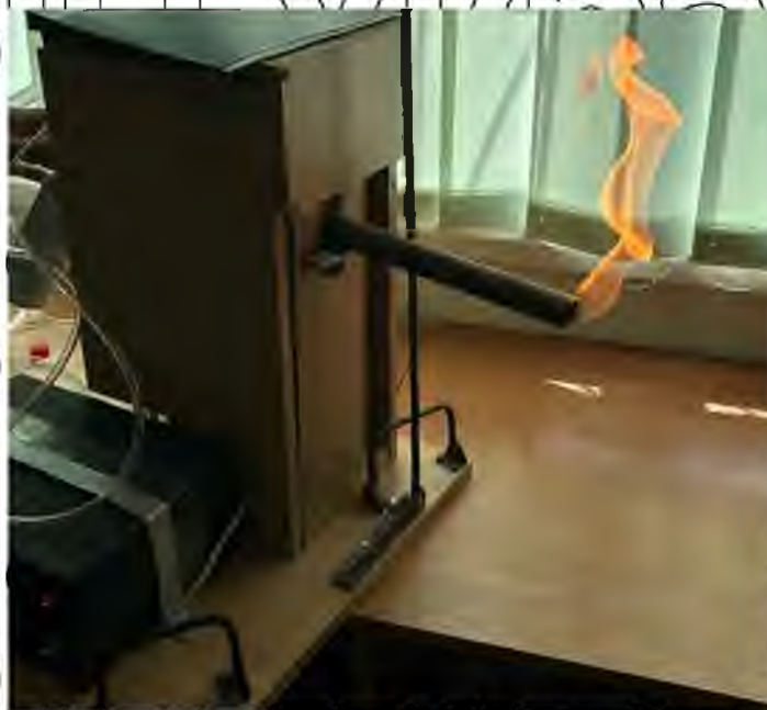
Рис.3.4. Факел при спалюванні газоповітряної суміші при електромагнітному впливі (температура полум'я та стримерів 180 °С)
