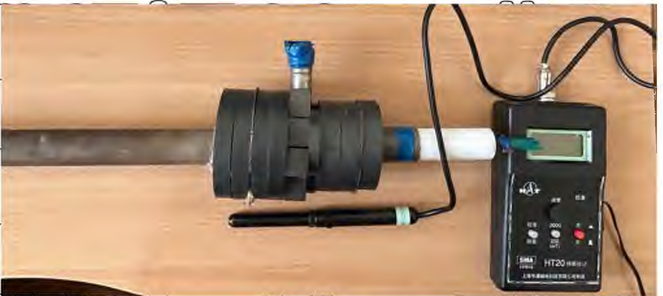
Рис.3.3. Пальник з системою магнітів
