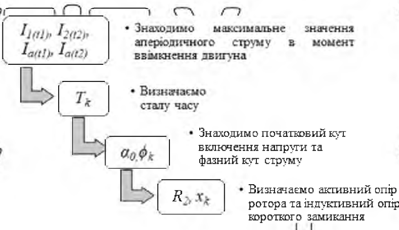
Рисунок 3.6 – Алгоритм проведення досліду з визначення параметрів
