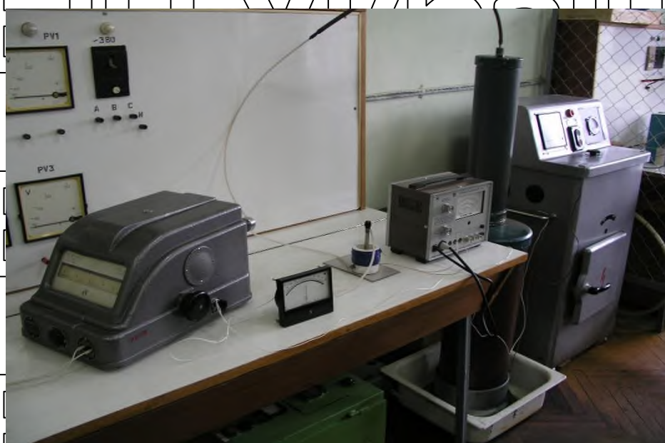
Рис. 3.12. Зовнішній вигляд установки з горизонтальними електродами для дослідження напруги початкової іонізації.
