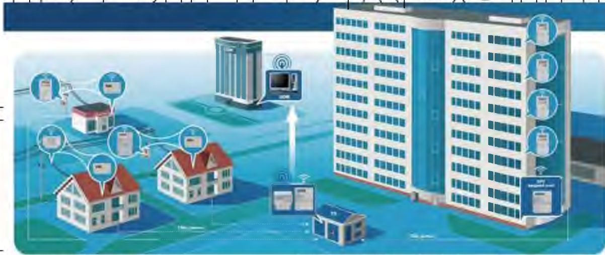
Рис. 2.4 Схема роботи АСКОВЕ на основі радіосигналу
