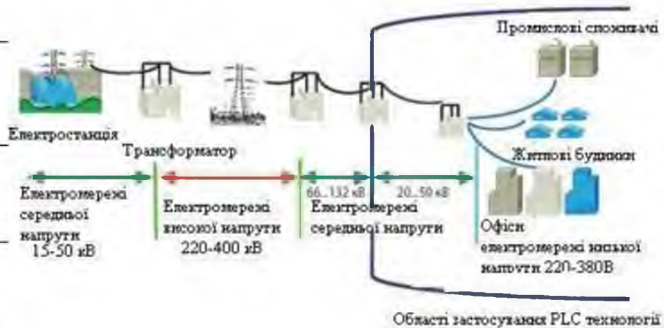
Рис. 3.2 Структура мереж електропередач та області застосування PLC-технології
