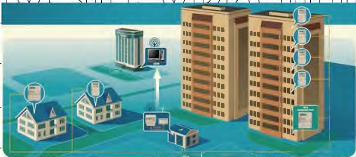
Рис. 2.3 Схема роботи АСКОЕ на базі PLC.
