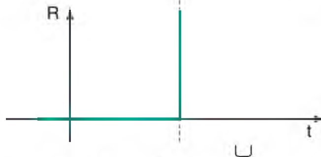
Рис. 1.1 Опис роботи ідеального вимикача
