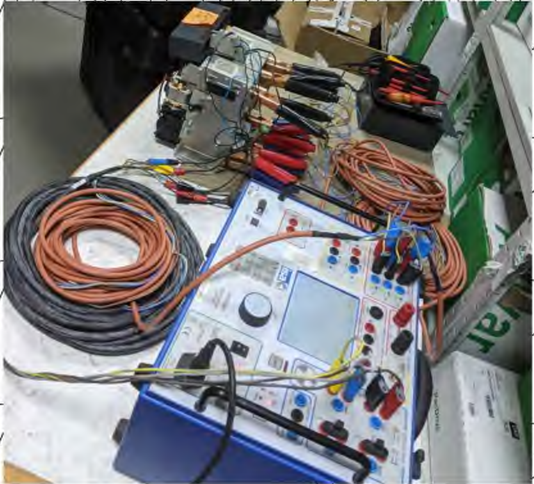
Рис. 5.7.1 – Виконання випробувань вакуумного вимикача в лабораторії
