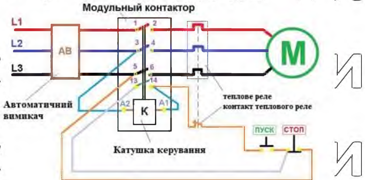
Рис. 1.10. Схема підключення трифазного електродвигуна через модульний контактор.
