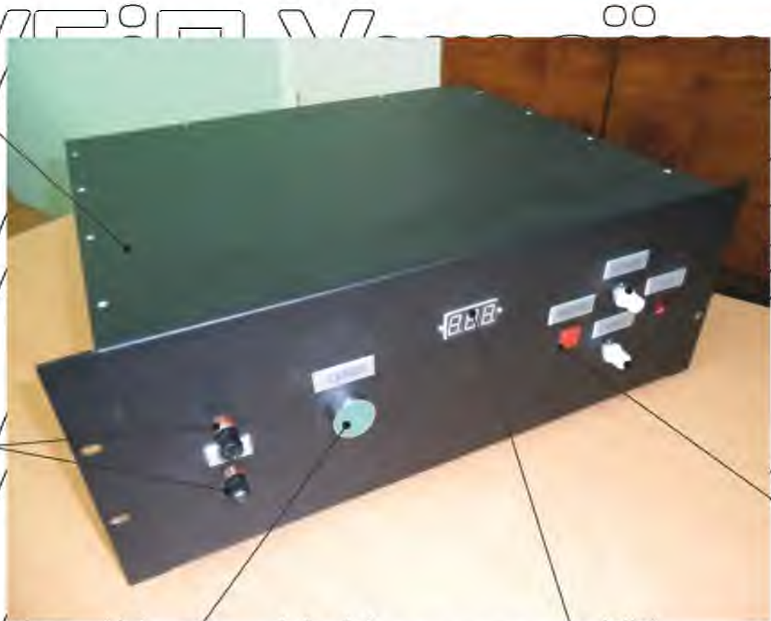
Рис. 3.8. Джерело імпульсів струму: 1 – корпус; 2 – виводи; 3 – «скидання» напруги; 4 – напруга на конденсаторі; 5 – «розряд»; 6 – регулятор для точного регулювання; 7 – «мережа»; 8 – кнопка для грубого регулювання.
