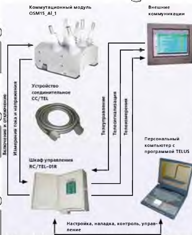
Рис.2.1. Принципова схема вакуумного реклоузера ROVU/TEL.
