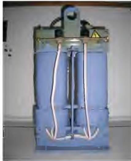
Рис. 3.7. Високовольтний трансформатор сухий ОСВ-1,5 220/15000
