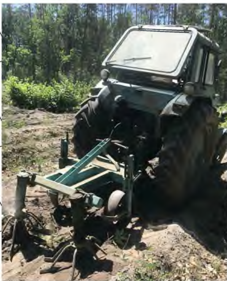
Рис. 2.1. Культиватор ротаційний лосовий КРД-1 в агрегуванні з трактором загального призначення Т-40 під час експериментальних досліджень
