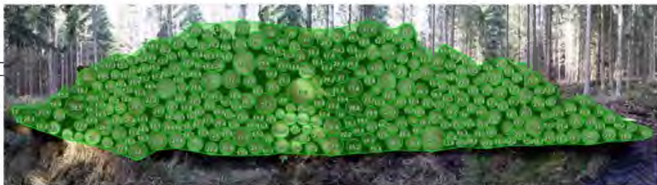
Рис. 1.2. Приклад штабеля деревини, записаного фотооптичною системою монокамери (Timbeter) [8]
