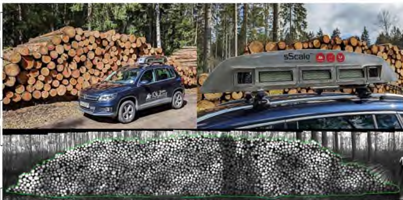
Рис. 1.3. Система Dralle sScale™, встановлена на автомобілі перед штабелем деревини [8]
