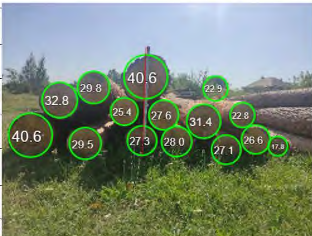
Рис. 3.1. Розрахунок об'єму штабелю за допомогою фотооптичних приладів на прикладі штабелю №1
