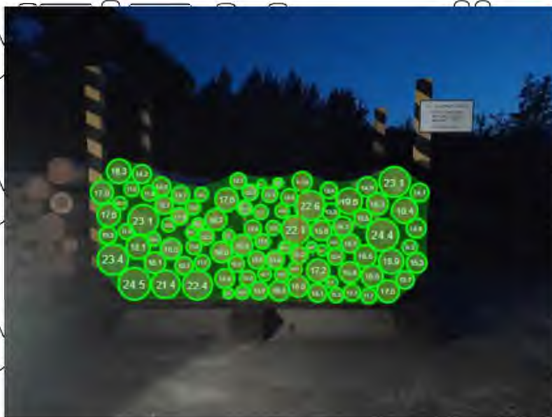
Рис. 3.3) Розрахунок об'єму штабелю за допомогою фотооптичних приладів на прикладі штабелю №3
