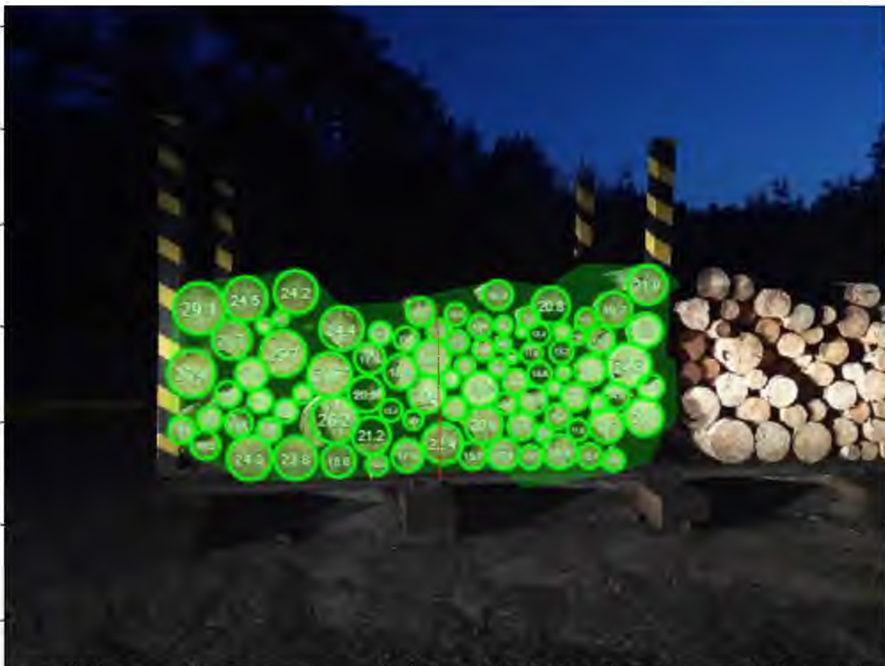
Рис. 3.4. Розрахунок об'єму штабелю за допомогою фотооптичних приладів на прикладі штабелю №4
