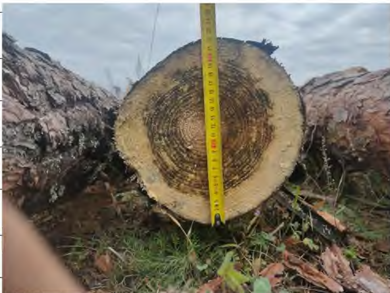
Рис. 2.8. Вимірювання діаметру дерева у верхньому відрізі без кори
