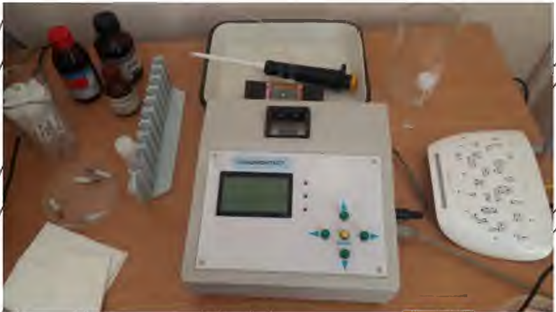
Рис. 2.3. Зовнішній вигляд ППР-біосенсора «Плазидтест»
