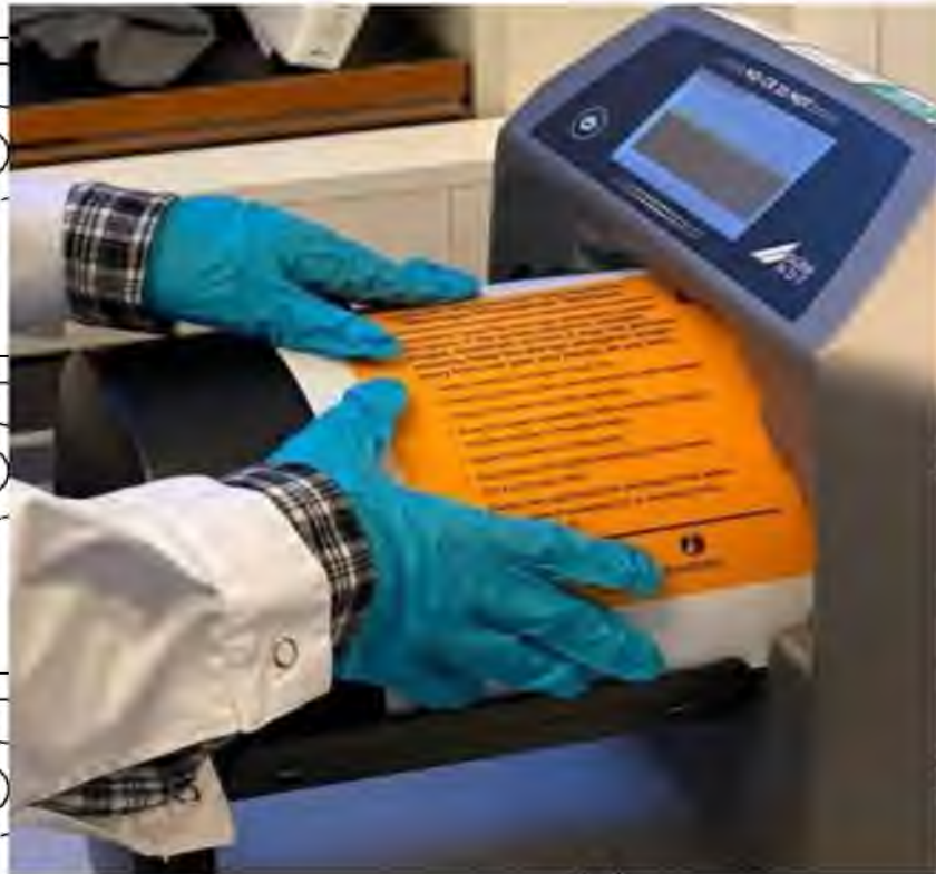
Рис. 2.6. Процес сканування рентгенографічних пластин
