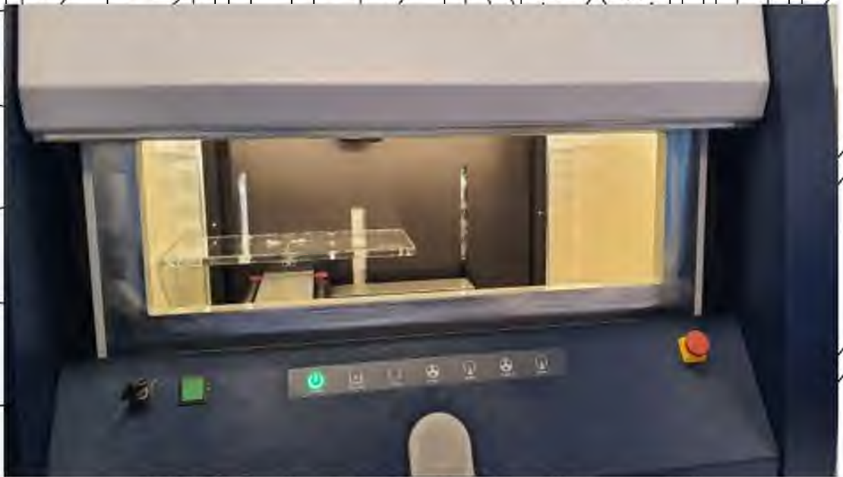
Рис 2.8. Процес встановлення зразка в M4 Tomado
