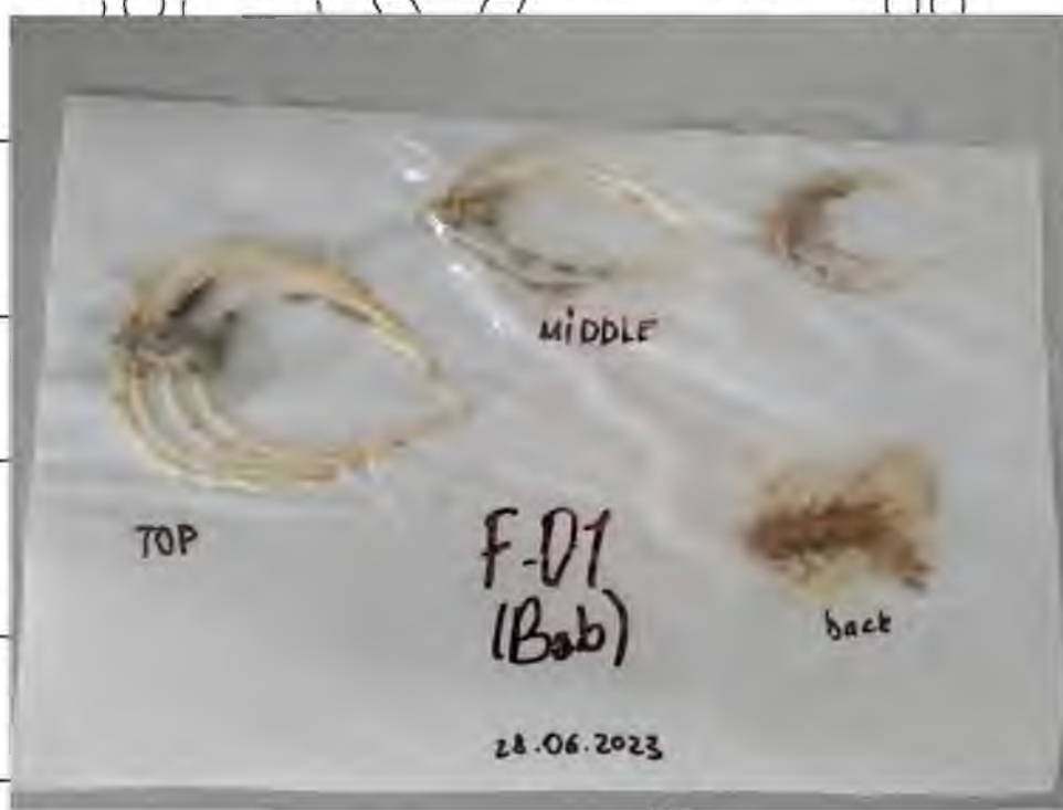
Рис. 3.1. Підготовлені зразки для проведення авторадіографії
