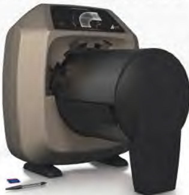
Рис. 2.1. Комплекс цифрової радіоавтографії CR 35/HD-CR 35 NDT Plus
