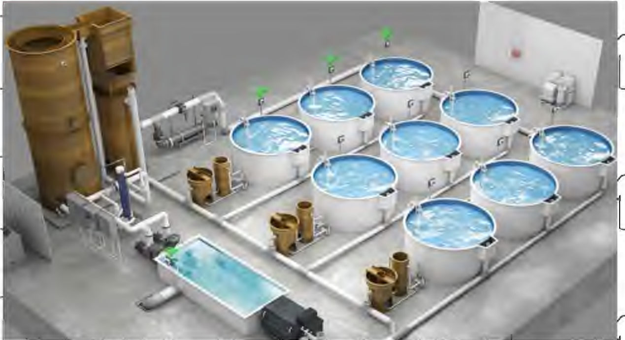
Рис. 3.1.1. Рециркуляційна аквакультурна система, або установка замкнутого водопостачання
