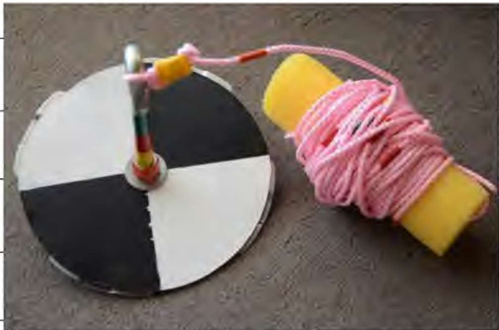
Рис. 2.2. Диски Секкі для досліджень прозорості води
