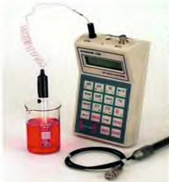
Рис. 2.3. Електронний прилад для визначення кількості кисню у воді
