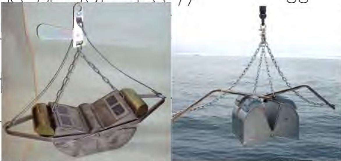
Рисунок 2.8. Дночерпаки різних конструкцій
