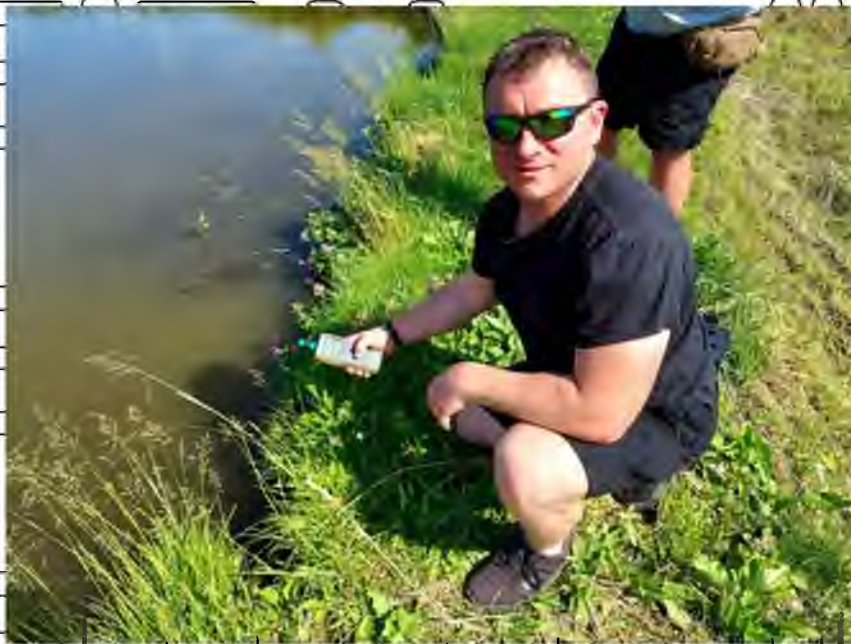
Рис. 2.5. Вимірювання кількості кисню та рН води у нижньому б'єфі Лисянської ГЕС
