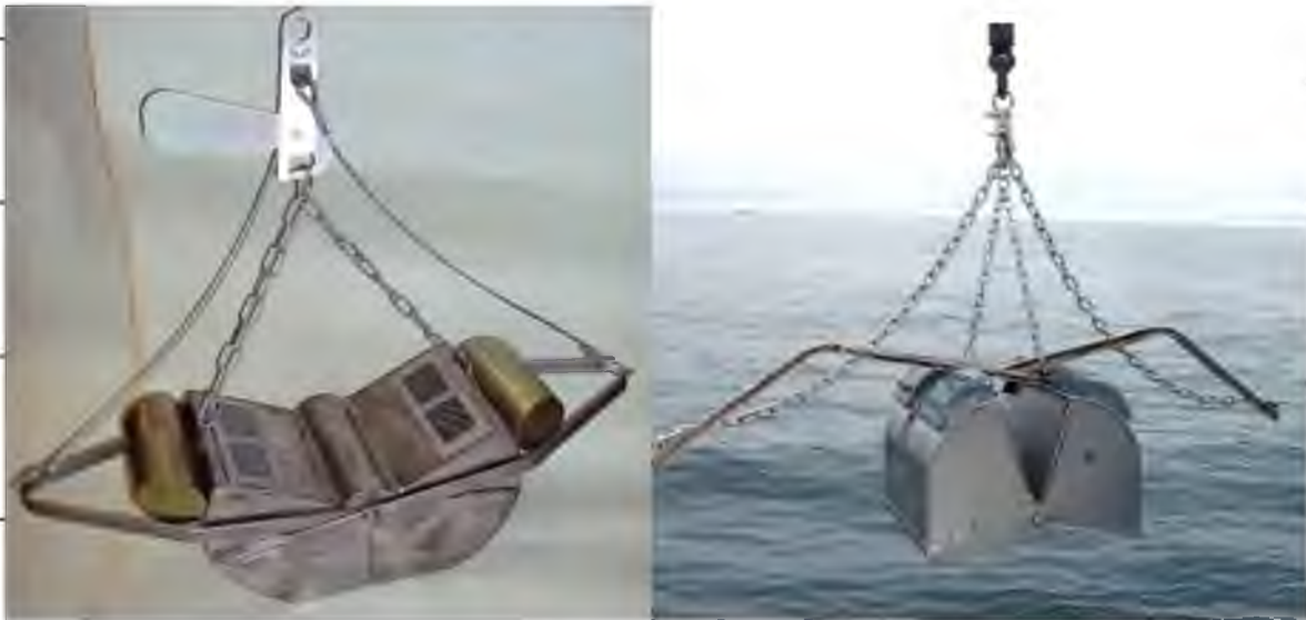
Рисунок 2.4. Дночерпаки різних конструкцій
