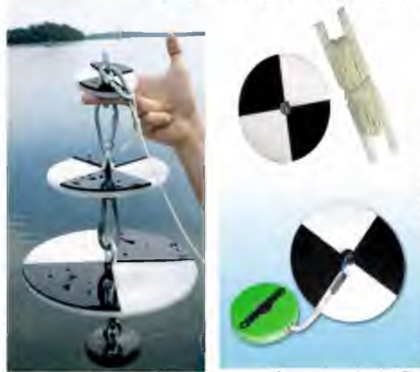
Рис. 2.2. Диски Секкі різних конструкцій для досліджень прозорості води
