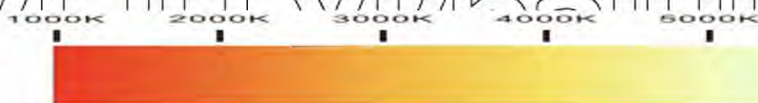
Рис. 2.1. Колірна температура світлодіодів
