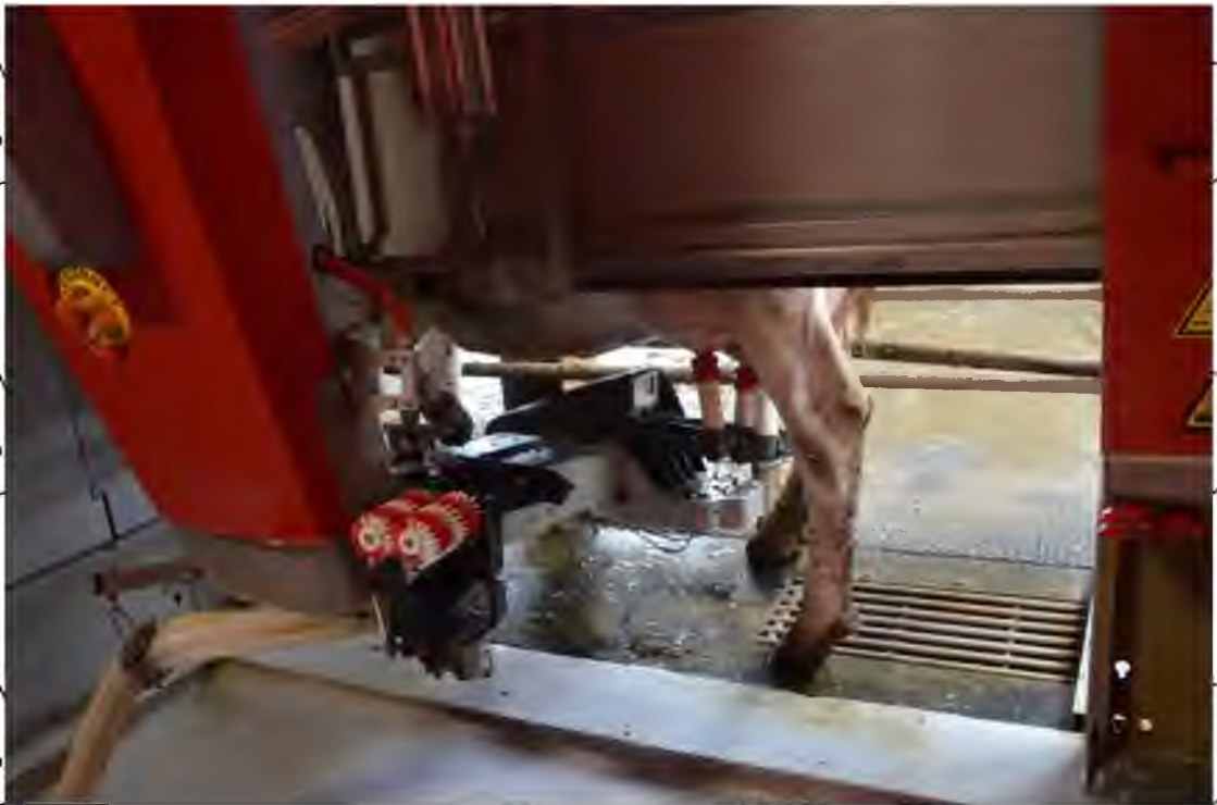
Рис. 3.1.5. Фрагмент доїння корови (VMS Lely Astronaut A-5).
