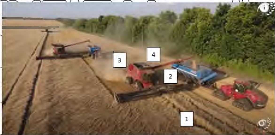
Рис.4.1. Небезпечні зони і фактори при збиранні пшениці яро: 1 – перед робочими органами працюючої техніки; 2 – в зоні між двома енергетичними засобами; 3 – позаду машини; 4 – фактор підвищеної запиленості.
