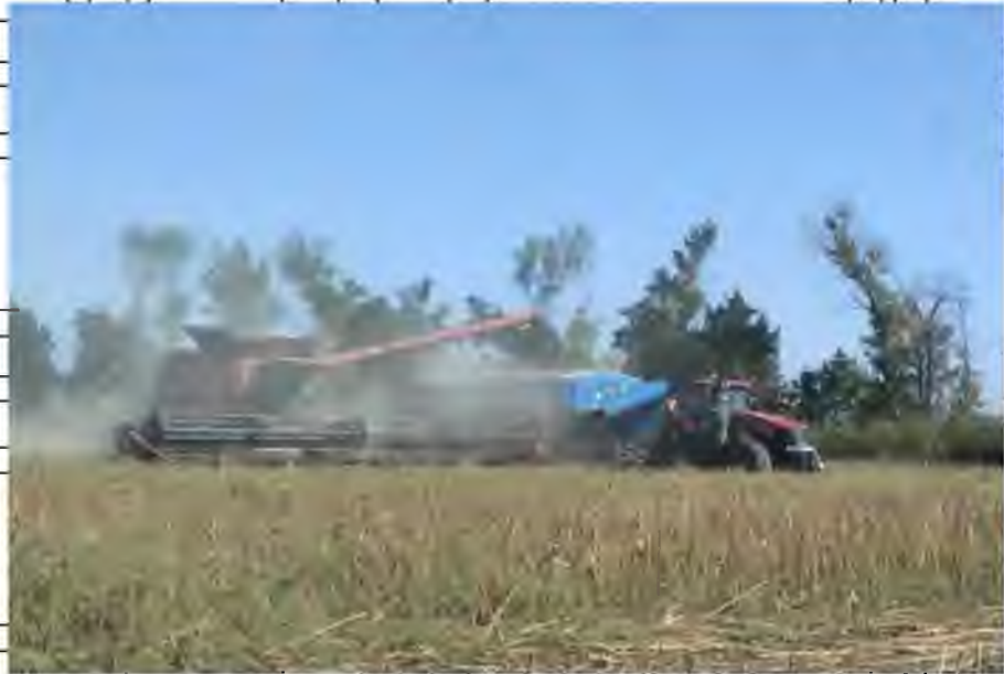
Рис.1.4 Момент вивантаження насіння соняшника в бункер-перевантажувач. Наступним етапом буде перевантаження насіння в автомобіль на краю поля.
