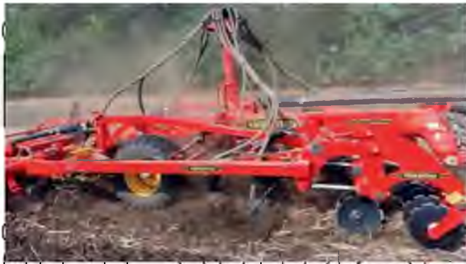
Рис. 1.26 Культиватор TopDown з аплікатором FH2200
