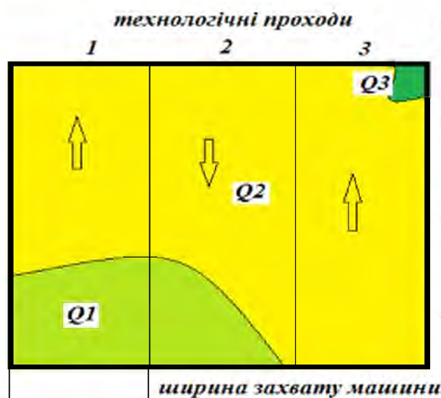
Рис. 1.31. Картограма частини поля із змінною нормою внесення мінеральних добрив.
