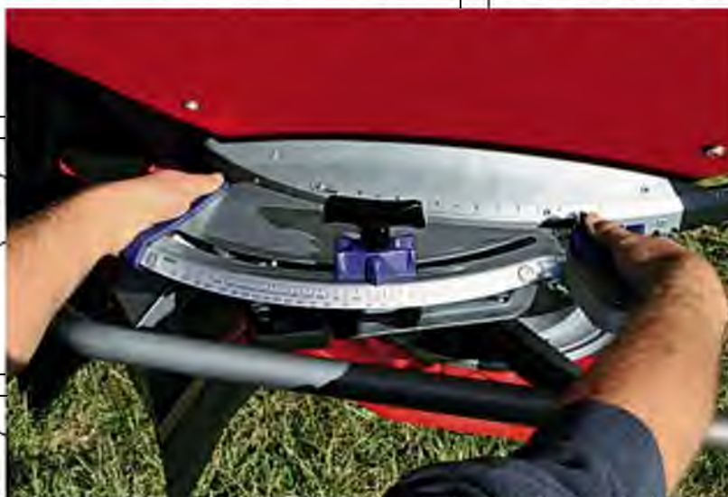
Рис.1.7. Система контролю потоку DFC.
