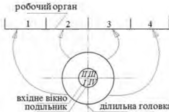
Рис. 2.22. Схема розподілу мінеральних добрив між технологічними смугами:
