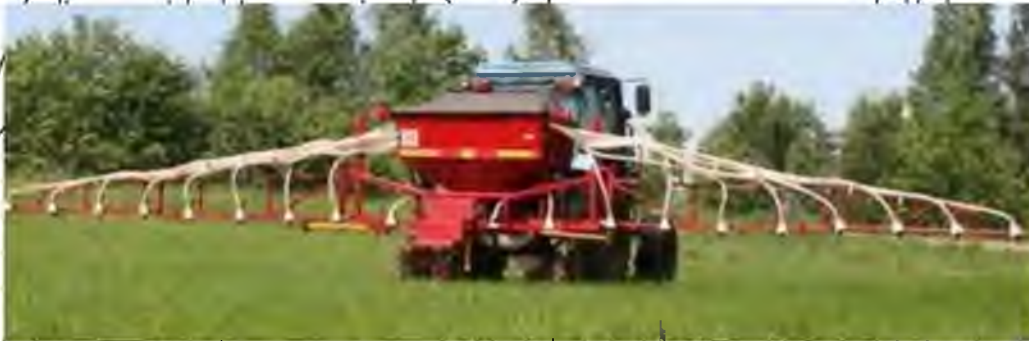
Рис. 1.30. Пневматичний літанговий розподільник твердих мінеральних добрив СУ-12 (Білорусь) з пневматичним розподілом потоку.
