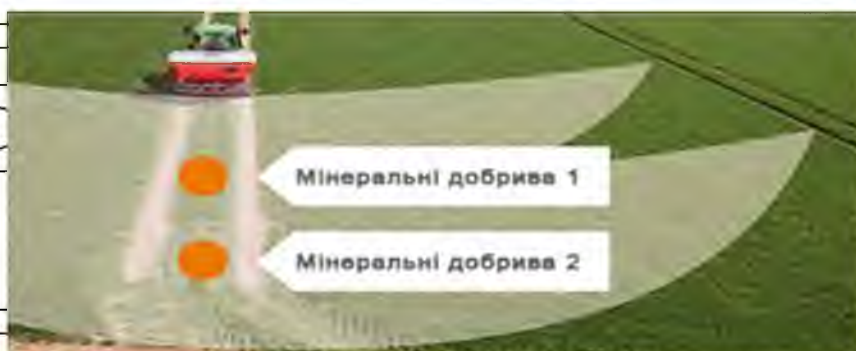
Рис.1.5. Якісний розподіл добрив на прикінцевих ділянках поля - система OPTIPoint.
