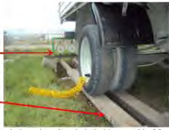
Рисунок 3.5 – Встановлення задніх коліс одного борту автомобіля на клавішному стенді [27]: 1 – клавіші; 2 – динамометр.
