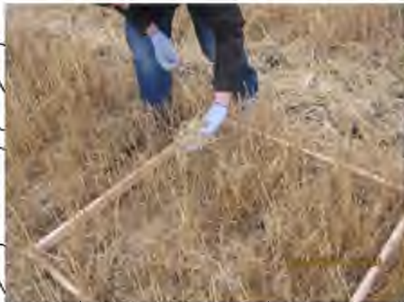
а) взяття проб на втрати зерна колосом за жнивркою комбайна
