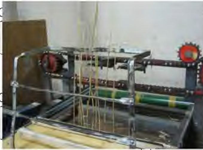
Рис. 3.5. Лабораторна встановлення для вивчення процесу подвійного зрізу
