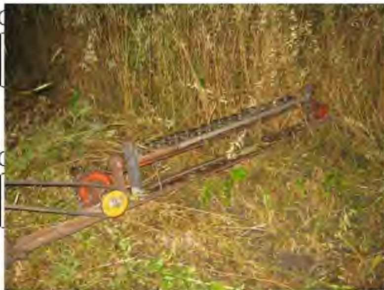
Рис. 4.7. Дослідний зразок ріжучого апарату з подвійним зрізом стебел
