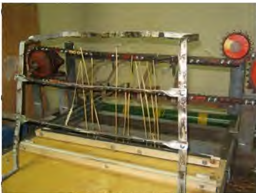
Рис. 4.5. Лабораторна встановлення ріжучого апарату з подвійним зрізом стебел
