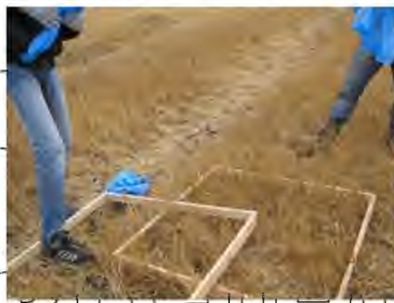
б) взяття проб на подрібнення соломи ПРС комбайна
