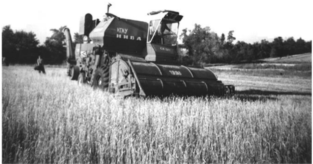
Рис. 4.5. Комбайн СК-5 "Нива" з експериментальним обчисувальним пристроєм
