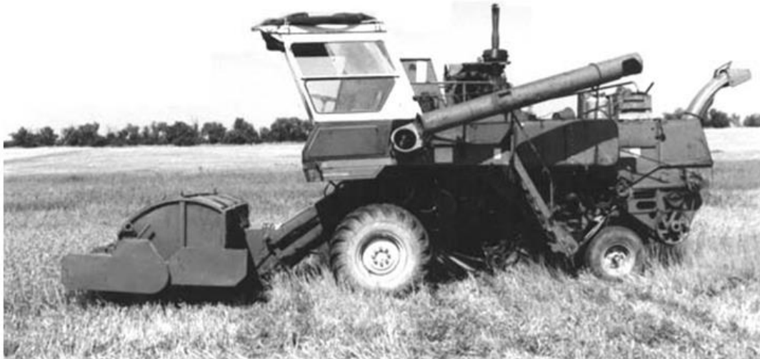
Рис. 4.2 Комбайн СК-5 "Нива" з експериментальним пристроєм для обчисування (вигляд збоку)
