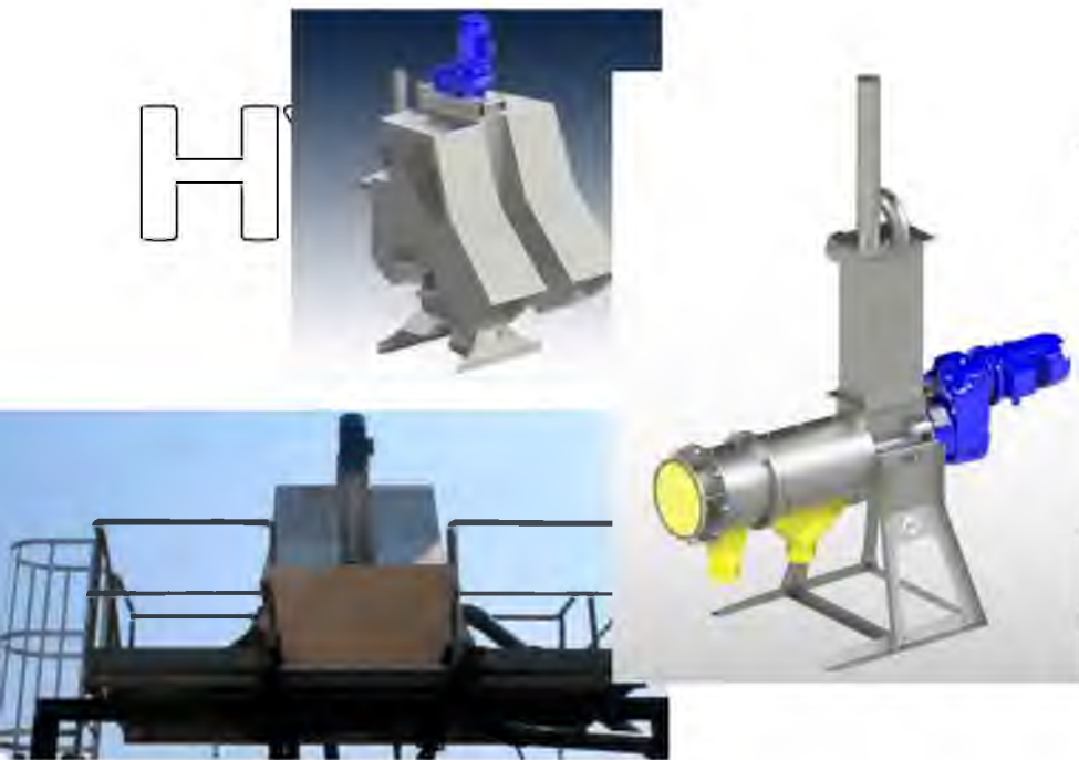
Рис. 3.5 – Сепаратор для розділення вихідної фракції з біогазової установки на рідку та тверду фракцію
