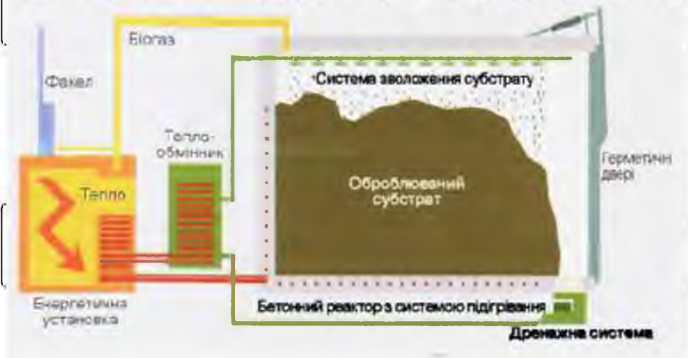
Рис. 3.3 Схема технологічного процесу BEKON Dry Fermentation.
