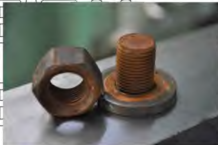
Рис. 3.6 - Різьбова пара після кородування розчином азотної кислоти
