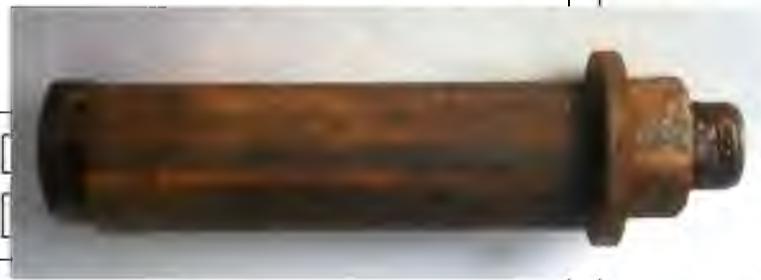
Рис. 3.5 - Різьбова пара в процесі кородування
