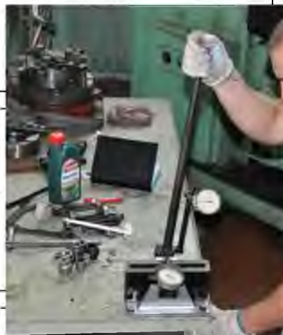
Рис. 3.2 – Вимірювання сили затягування
