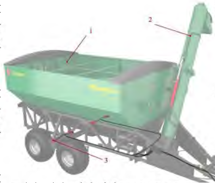
Рис. 1.9 – Бункер-перевантажувач: 1 – бункер; 2 – вивантажувальний шнек; 3 – теїзодатчик.
