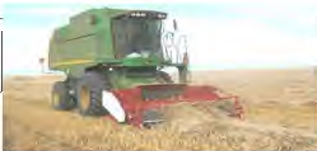
Рис. 4.3. зернозбиральний комбайн «John Deere 9570», оснащений платформою-підбирачем, на підборі валка хлібної маси
