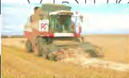
Рис. 4.13 Підбирання контрольного валка хлібної маси зернозбиральним комбайном TORUM 440
