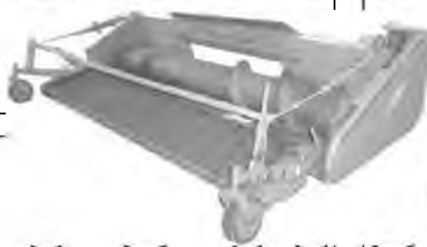
Рис. 1.9. Платформа-підбирач валків ПН-836
