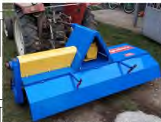
Рис. 5.7. Зовнішній вигляд захисного ножа на навісній ґрунтофрезі мінітрактора
