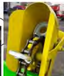
Рис. 5.5. Схема улаштування захисного кожуха на фрезерувальному приєднанні для оброблення ґрунту: 1 – робочі ножі; 2 – ведений диск; 3 – провідний диск; 4 – захисний кожух; 5 – решітка
