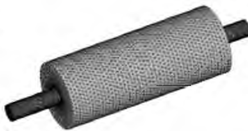
Рисунок 2.2 - 3-х мірна кінцево-елементна модель елемента SOVG
