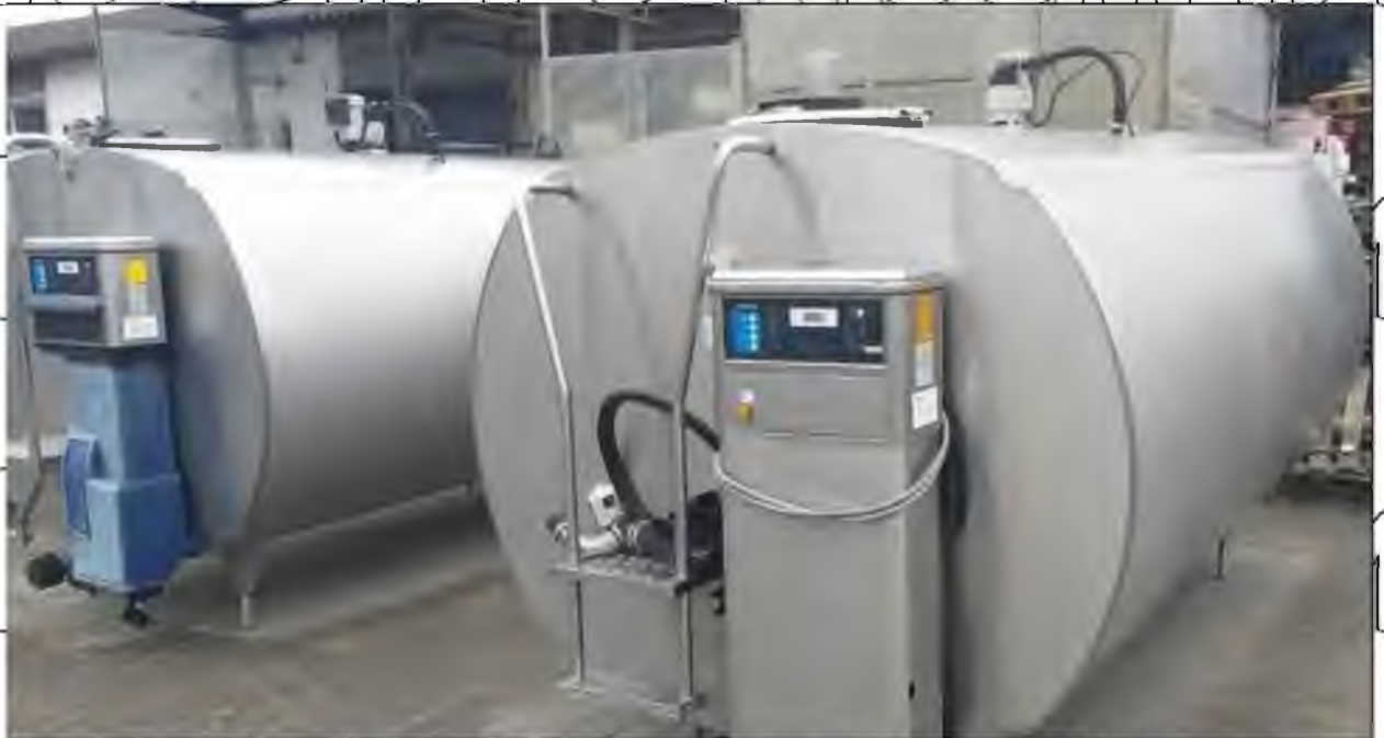
Рис. 2.6 Танк-охолоджувач молока DeLaval DX/CE
