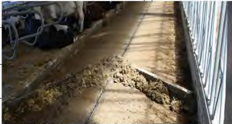
Рис 2.4 Робота скреперної установки Брацлав УС-100
