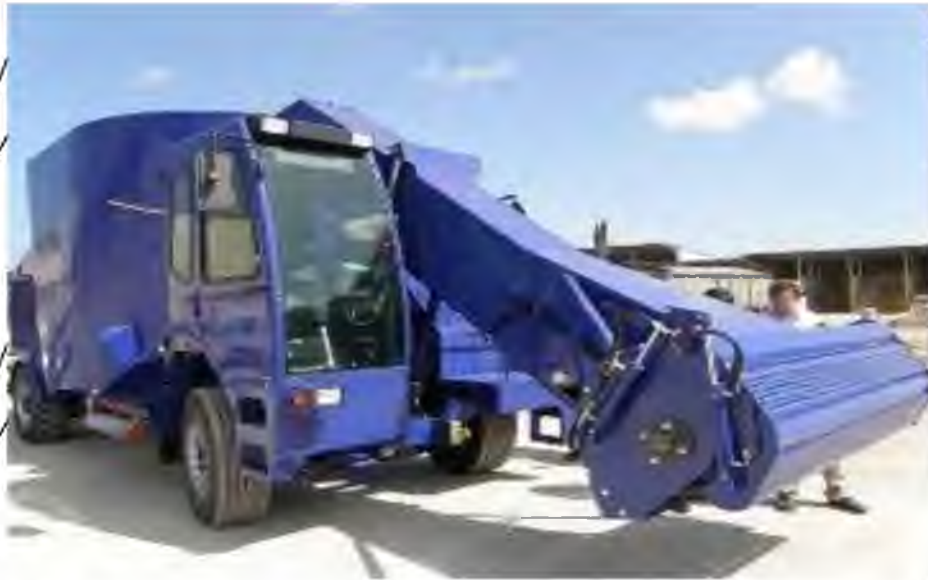
Рисунок 2.3 Самохідний змішувач-роздавач Sioking, оснащений навантажувальною фрезою
