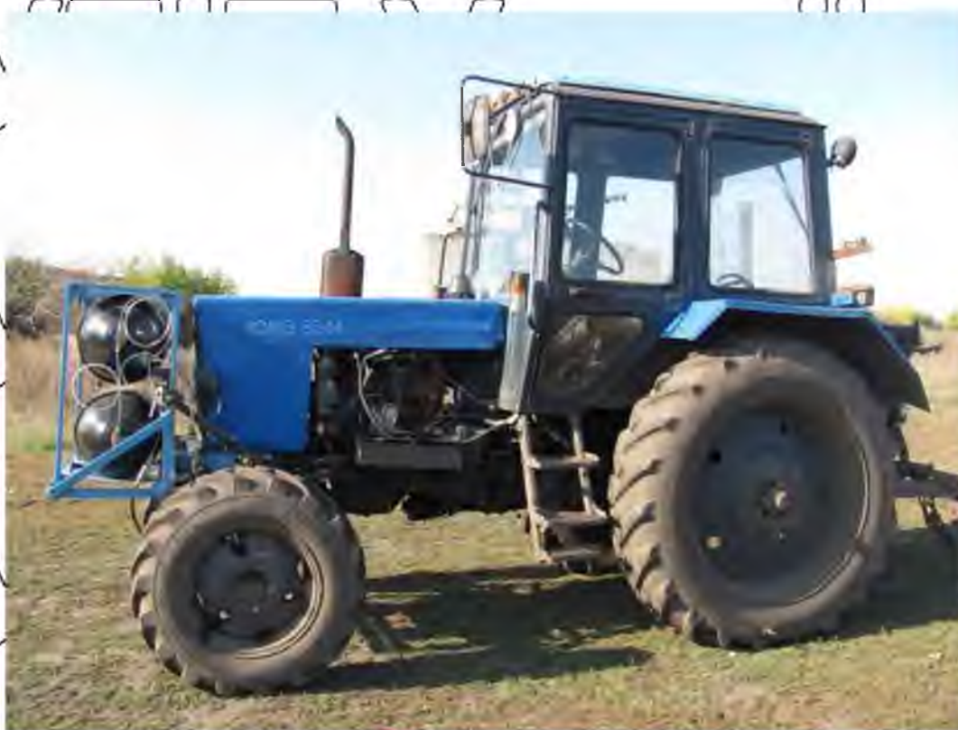
Рисунок 4.1 – Загальний вигляд трактора ЮМЗ-8244, оснащеного газобалонним обладнанням
