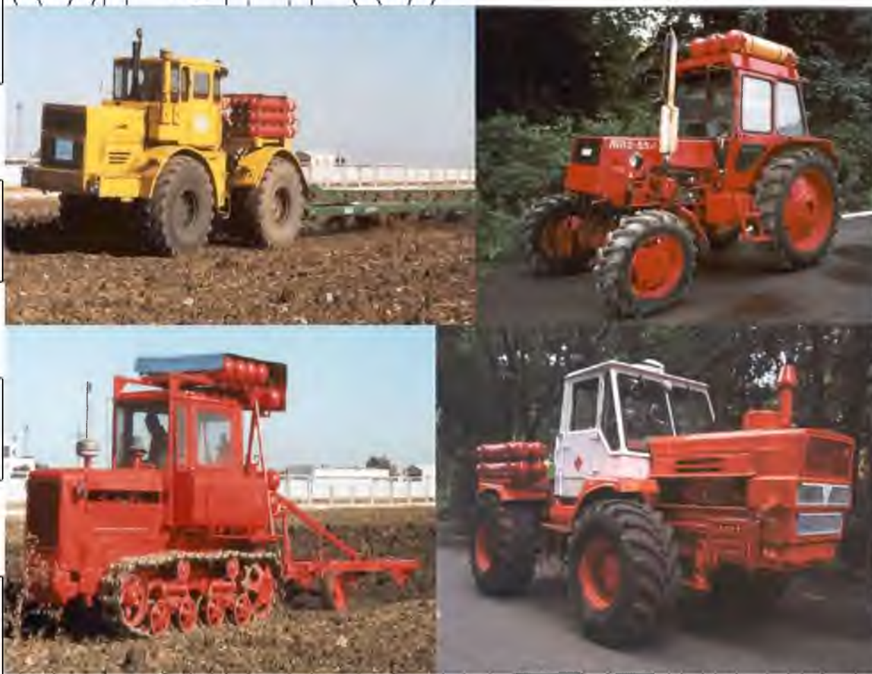
Рисунок 1.1 – Сільськогосподарські трактори з газобалонним обладнанням
