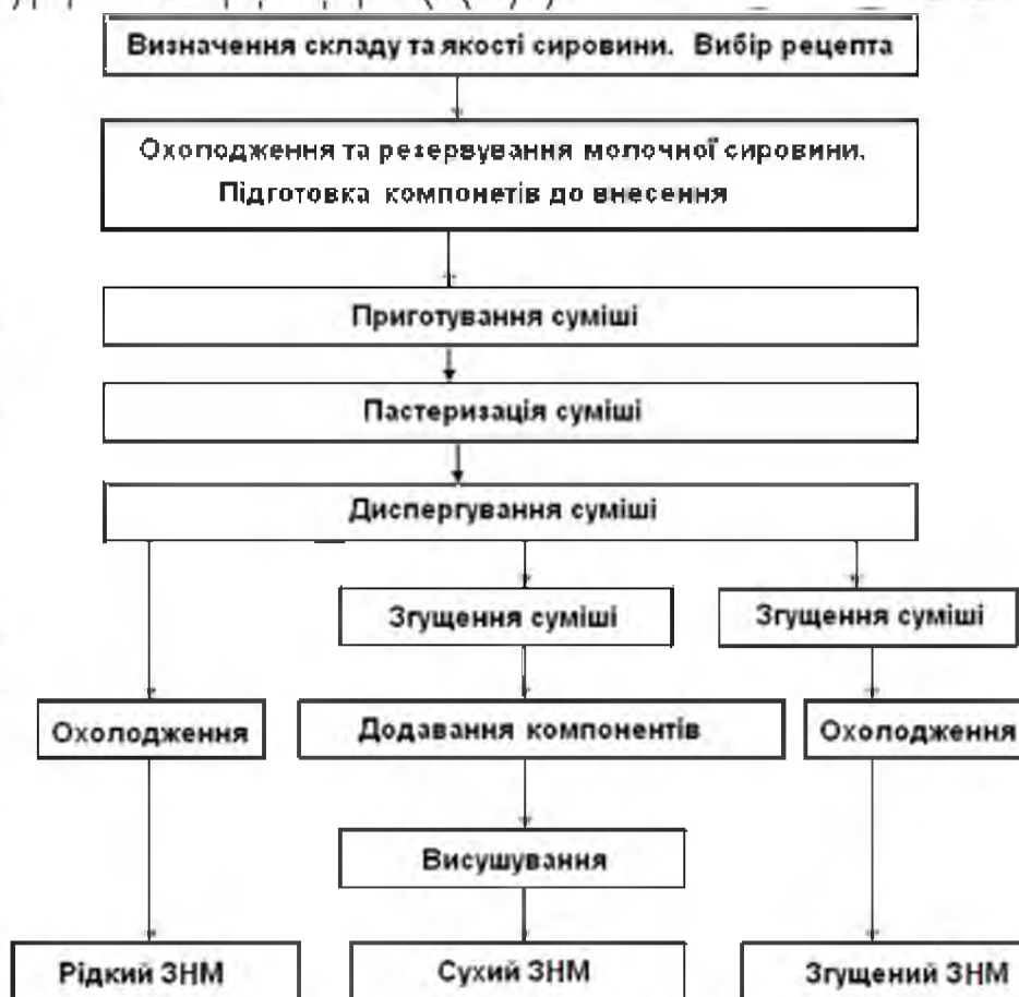
Рис. 3.3. Технологічна схема виробництва ЗНМ
