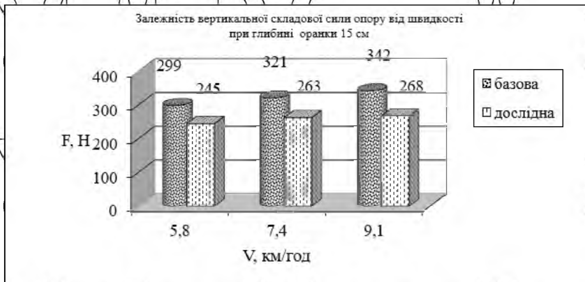
Рис. 3.7 Залежність вертикальної складової сили опору від швидкості при глибині оранки 15 см
