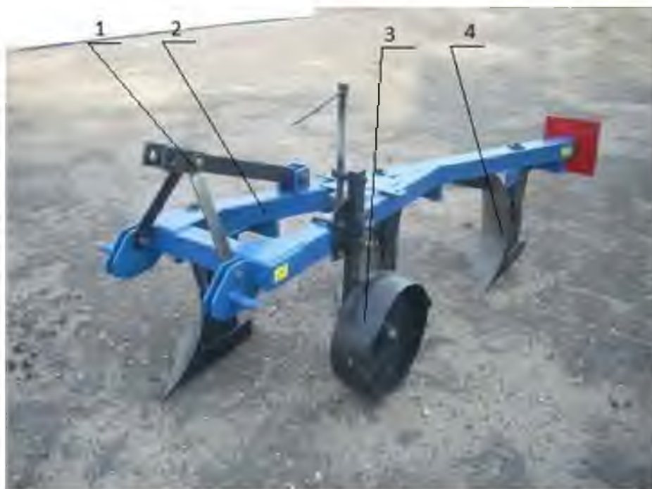
Рис. 2.1 Плуг трьохкорпусний навісний УМН-3-35: 1 - причіпний механізм; 2 – передплужник; 3 - опорне колесо; 4 - корпус плуга; 5 - причеплення для борін; 6 – рама.
