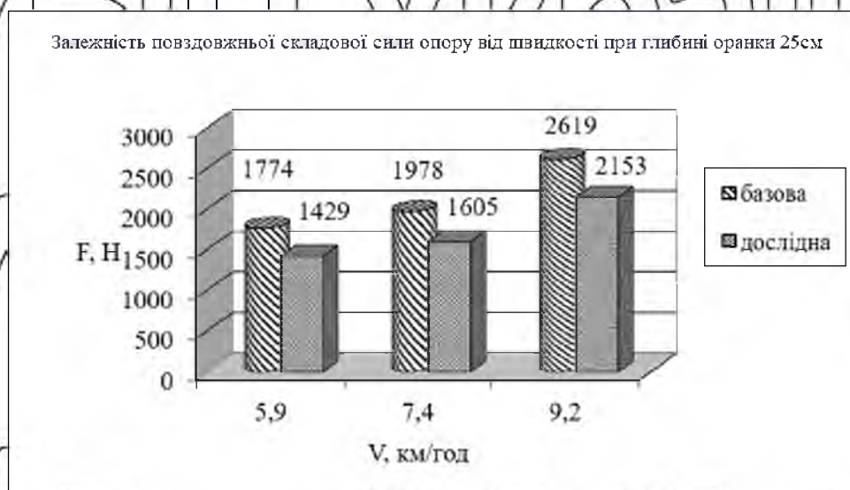
Рис. 3.3 Залежність поздовжньої складової сили опору від швидкості при глибині оранки 25см
