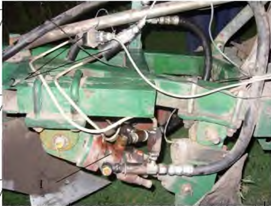
Рис. 19. Розміщення перетворювача тиску ИПД 2:
