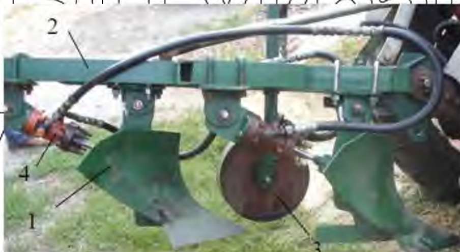
Рис. 16. Спеціально підготовлений експериментальний віброплуг ПЛН – 2–25, з двома гідравлічними вібраторами
