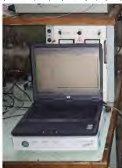
Рис. 22. Підсилювач-перетворювач SPIDER-8-30 та персональний комп'ютер HP6100 з програмним продуктом Catman Express 4.5
