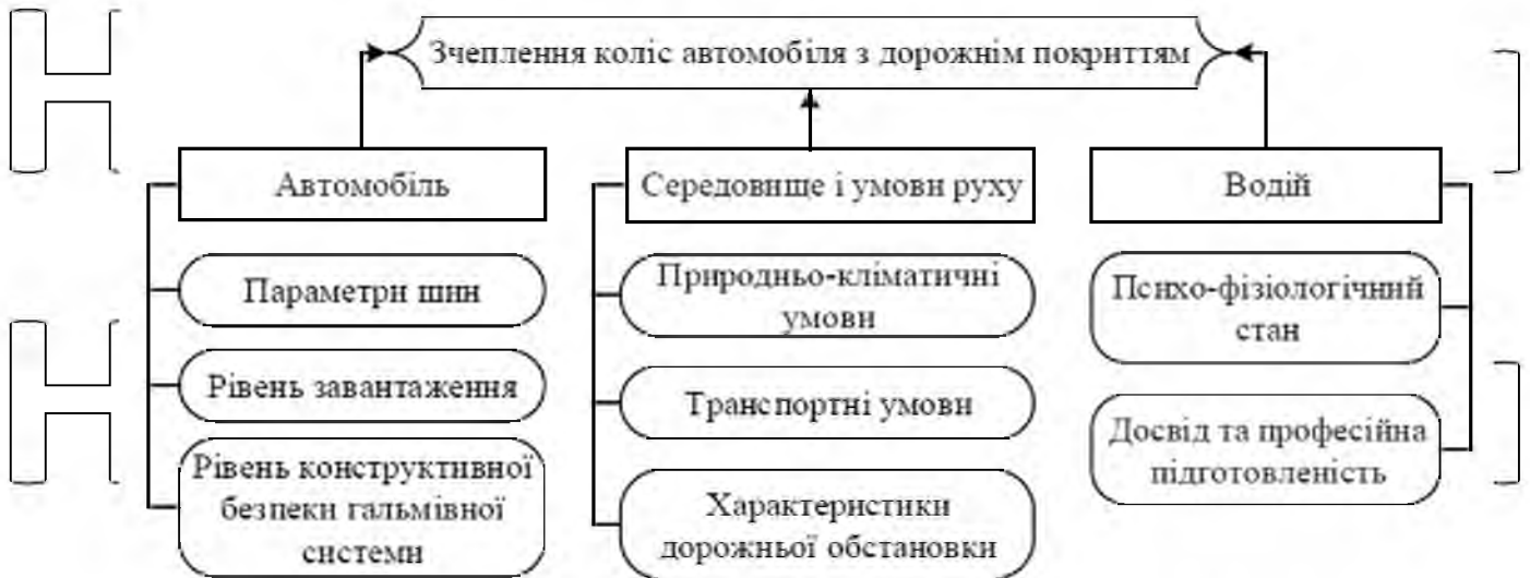
Рис. 3.6 Фактори, що визначають потенціал реалізації зчепних властивостей коліс автомобіля з дорожнім покриттям
