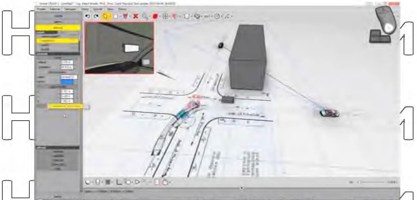
Рис. 2.1 Приклад дослідження ДТП на основі слідової інформації з місця ДТП у програмі Virtual Crash 3.0
