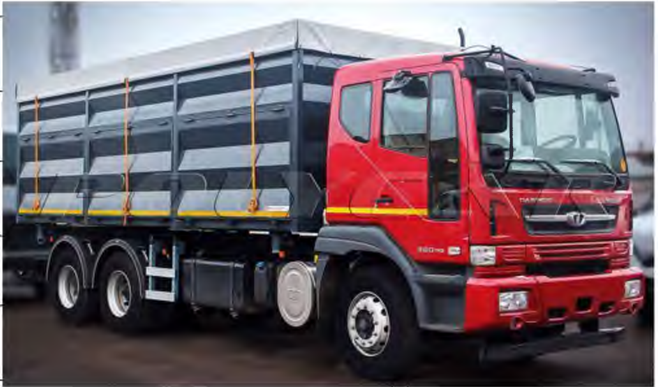
Рис. 1.4 Сучасні автомобілі - самоскиди: а) сучасні зерновози; б) самоскид на шасі FOTON AUMAN GTL BJ 3319/GMW 507. (колісна база 1800+3950+1350 мм); в) зерновоз із самоскидним кузовом на шасі вантажного автомобіля Daewoo Maximus
