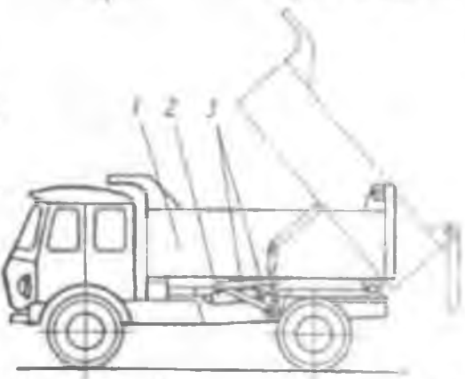
Рис. 1.2 Принципові схеми основних типів автомобілів-самоскидів
