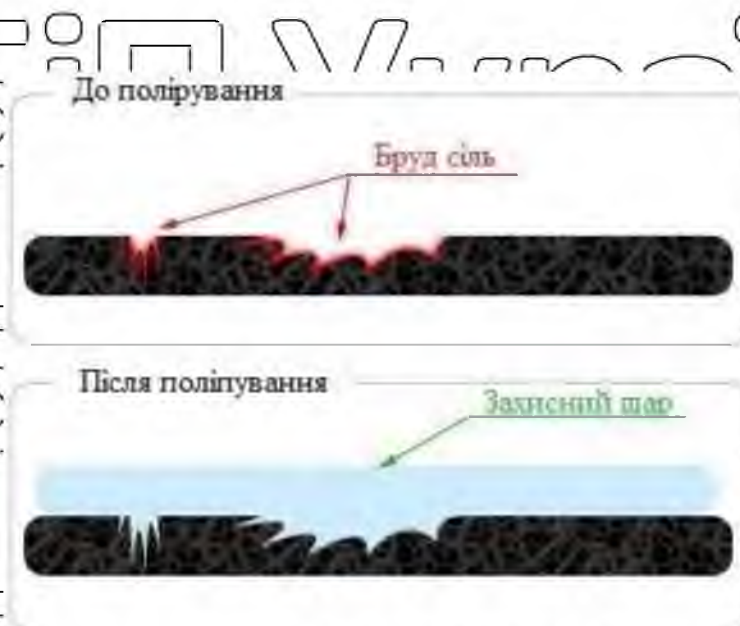
Рисунок 1.4 – Схема захисного полірування [6]
